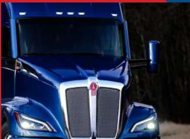
Capó de tres piezas hecho de Metton duradero y ligero con excelente resistencia al impacto, integrado con parrilla estilizada de aluminio resistente a la corrosión, con fácil apertura.
