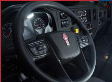
Permite controlar las funciones del vehículo, como: control crucero, establecer velocidades límite, funciones de entretenimiento, configurar la pantalla digital, contestar y terminar llamadas telefónicas.
